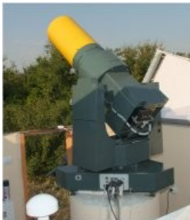
Фиг. 1 (а,б) Фотографска камера АФУ-75 (а) и лазерен далекомер УЛИС (б), монтирани в Наблюдателната станция на ИСЗ на Старозагорските минерални бани
