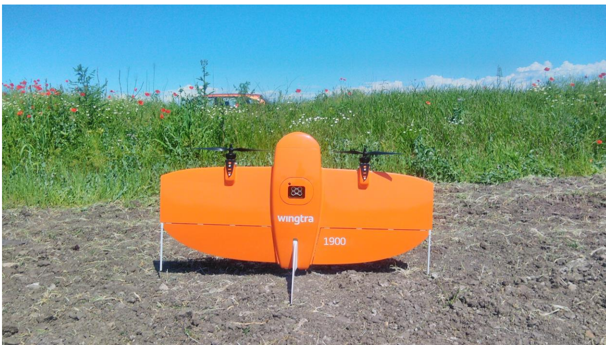
Фигура 6 БЛА тип крило марка WingtraOne използван в изследването
