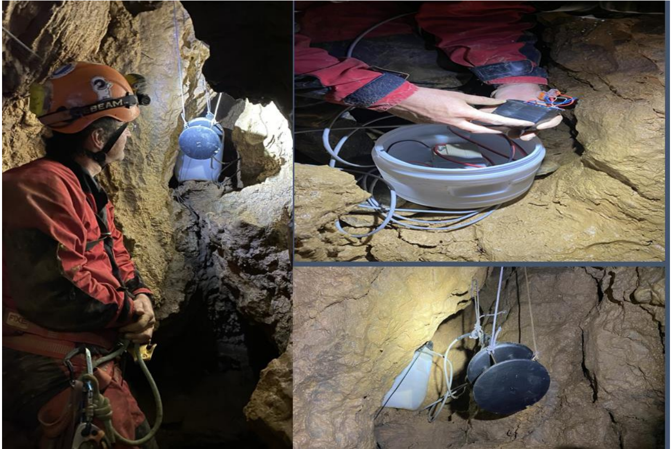
Фигура 10. Позиция и монтаж на анемометъра на дълбочина от -60 метра
