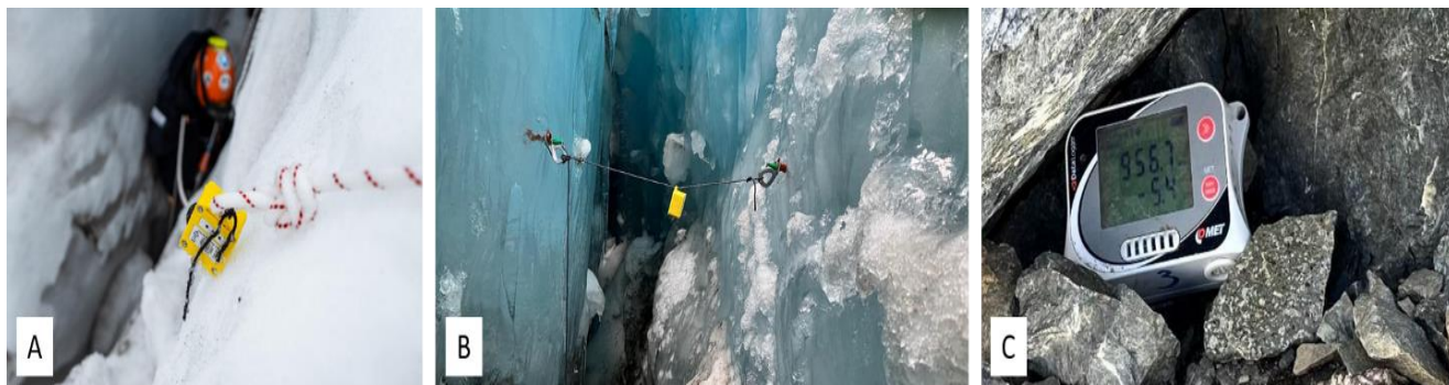
Фигура 20. Сензори: А и В – Сензори за измерване на температурата на въздуха в пукнатините на ледник „Джонсън“, С – Външни метеорологични датчици Comet U4130
