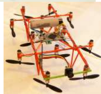
Фиг. 2. Иновативни многороторни БЛА за дистанционни изследвания: горе – 36-роторен дрон; долу вляво – 16-роторен мултикоптер; долу вдясно: 12-роторен БЛА
