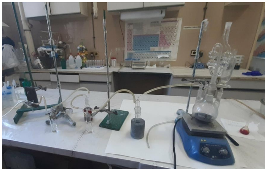
Фиг. 3. Експериментална установка за определяне на съдържанието на ^{14}\text{C}
