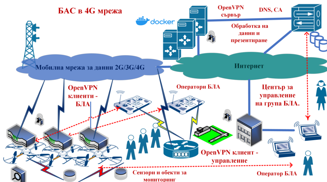
Фиг. 1. Структура на БАС в 4G мобилна мрежа и управление през Интернет
