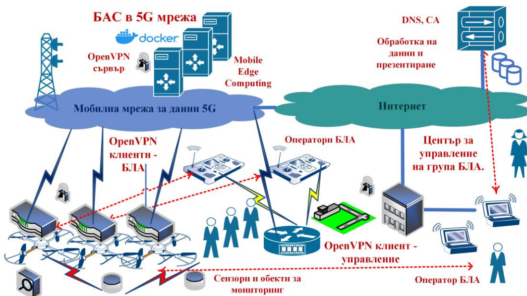
Фиг. 2. Структура на БАС в 5G мобилна мрежа и управление през Интернет
