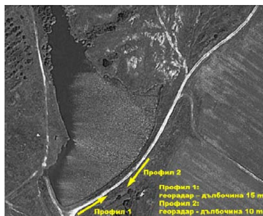
Фиг. 2. Положение на георадарните замервания на язовирната стена, яз. Блатница
