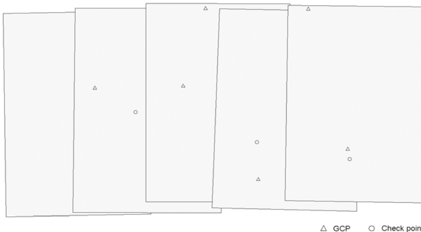
Фиг. 2. Разположение на опорните и точките за проверка на точността на аероснимките от камера МКФ-6
