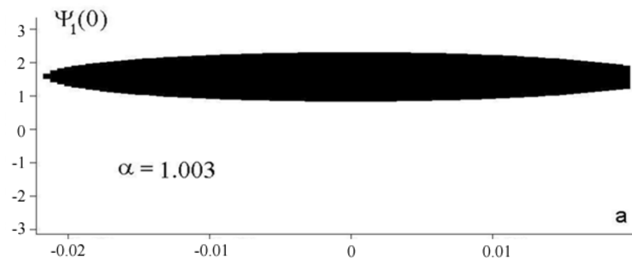
Фиг. 9. Область захвата частиц в режим ультрарелятивистского ускорения на плоскости начальных данных; при расчетах шаг по начальной фазе \delta\Psi_1(0) = 0.02 , по скорости он соответствовал \delta a = 0.0005 , время счета \tau = 100000 .
