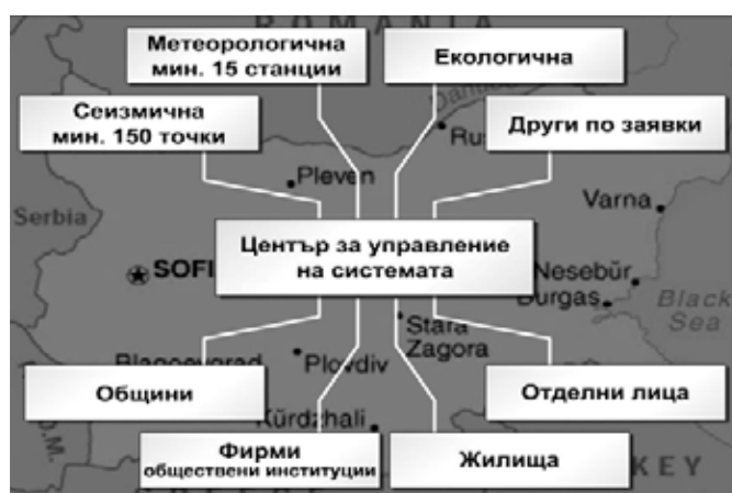
Фиг. 1. Принципна схема на системата за ранно оповестяване на природни бедствия
