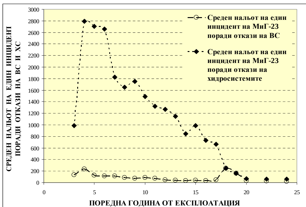
Фиг. 2. Средни нальоти на един инцидент на самолет МиГ-23 поради отказ на ВС като цяло и на хидросистемата в зависимост от годините на експлоатация
