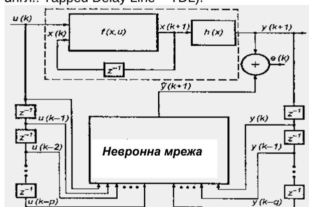
Фиг. 1. Метод за включване на невронната мрежа за идентификация на динамичен обект на РТС
